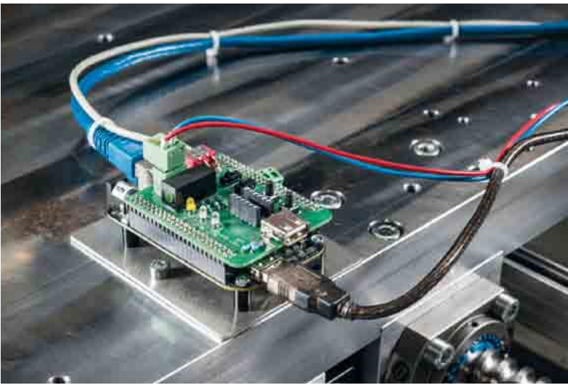
BeagleBone zur Speicherung und sicheren Übermittlung von Daten an die Maschinensteuerung
