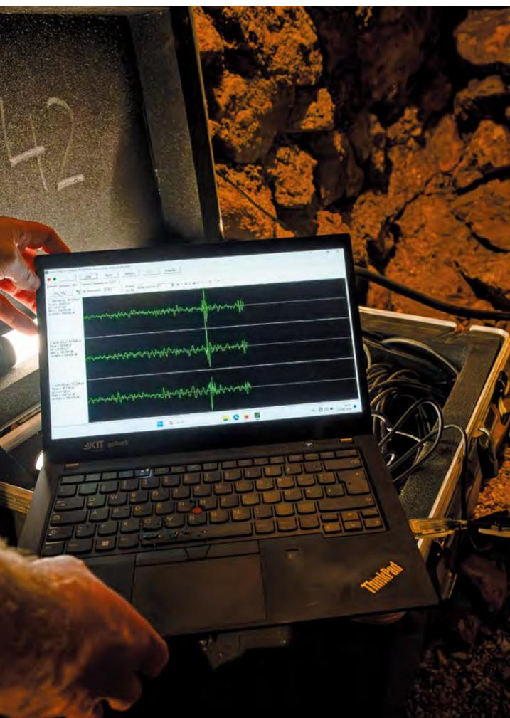
*In der Messkammer des Black Forest Observatory (BFO) zeichnen empfindliche Instrumente seismische Aktivitäten auf*
