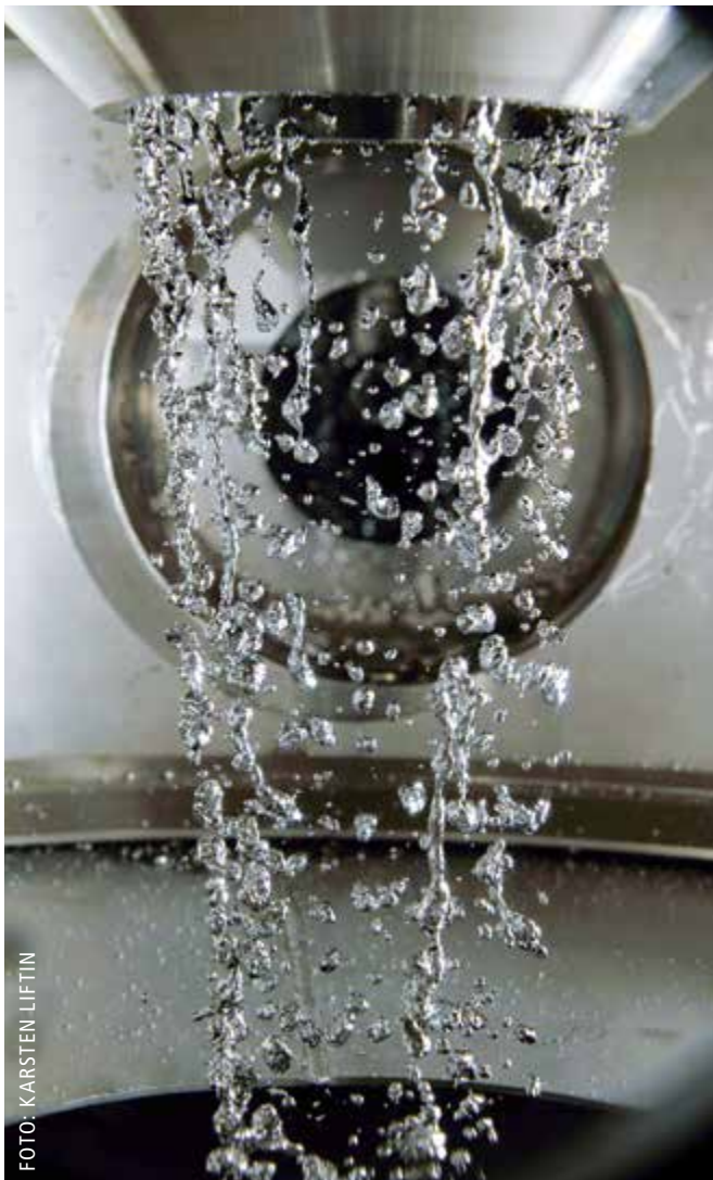
Im Wärmespeicher (siehe Schema) wird flüssiges Blei-Bismut als Wärmeträger eingesetzt Liquid lead-bismuth is used as a heat transfer medium in the heat storage system (see schematic representation)
