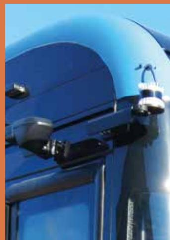
*Zur optischen Abstandsmessung ist ein Light Detection and Ranging (LiDar)-System an den Bussen angebracht*
