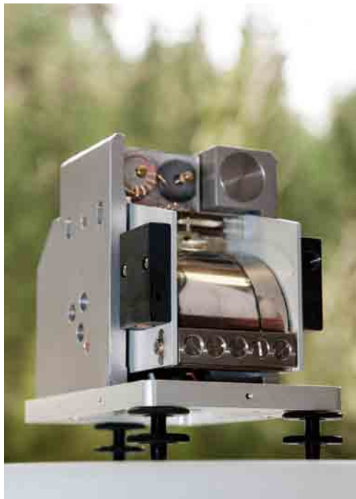
Das „Innenleben“ eines Breitbandseismometers aus der Baureihe der derzeit empfindlichsten Instrumente zur Beobachtung von Eigenschwingungen des Erdkörpers
