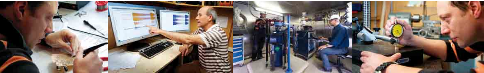
Techniker Peter Duffner vom Geodätischen Institut repariert defekte Messgeräte und baut neue Komponenten (Foto ganz links und rechts), Dr. Rudolf Widmer-Schnidrig (2. Foto von links) zeigt Erdbeben-Ausschläge am Rechner. Unter Tage: Dr. Thomas Forbriger und Peter Duffner bei einer Wartung des supraleitenden Gravimeters
