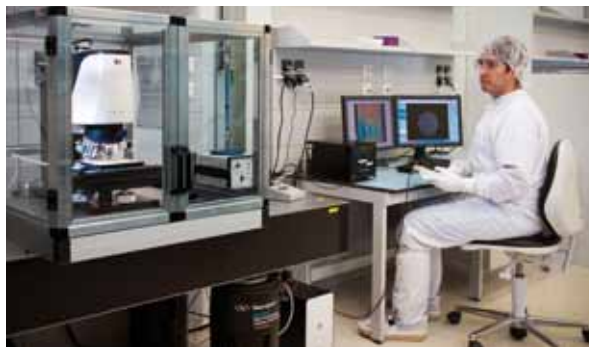
Im Labor arbeitet Dr. Hernandez-Sosa mit einem Weißlicht-Interferometer (re.), einem speziellen Lichtmikroskop, um die Qualität des Druckprofils zu überprüfen, sowie mit unterschiedlichen Drucksystemen, darunter auch solche mit Tintenstrahl-Technologie (li.)
