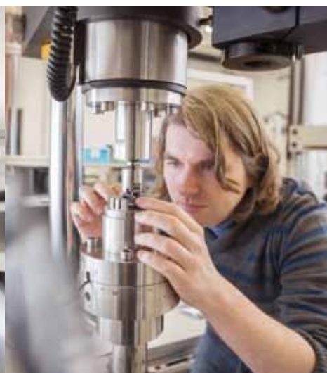
Dr. Günter Schell beim Einbau einer Probe zur Festig- keitsbestimmung
