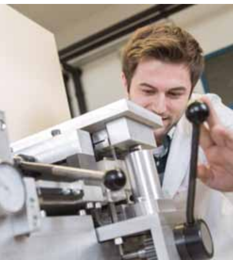
Rafael Mrozek, Doktorand, arbeitet an einem Messplatz zur Bestimmung weichmagnetischer Eigenschaften
