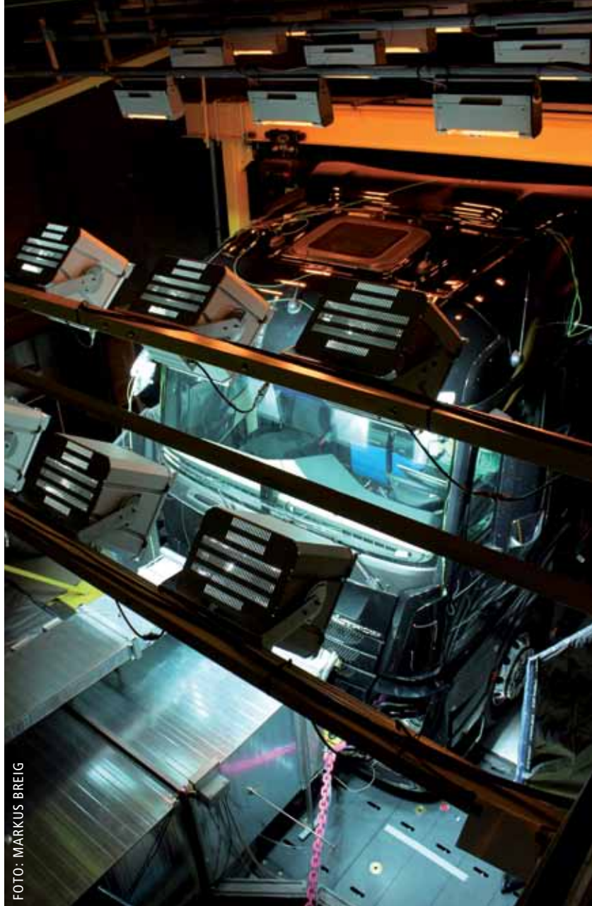
Kombinierter Einsatz von Sonnensimulations- und Infrarotstrahlern
