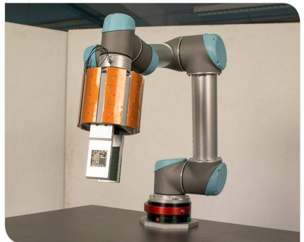
Ein 6-Achs-Roboterarm mit einem MRK-Greifer
