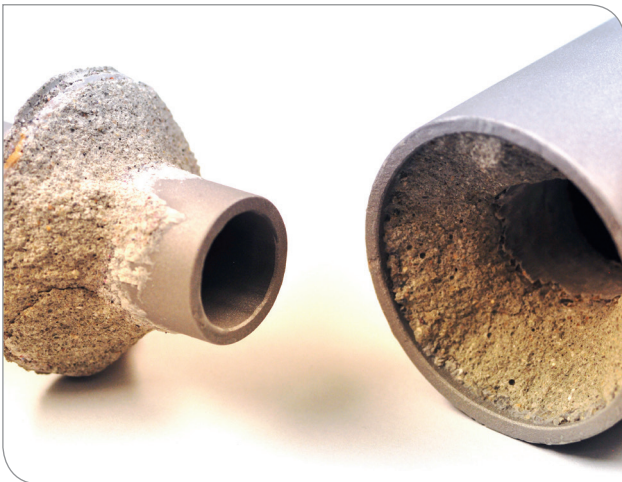
Bruchbild der Verbindung zweier Hohlprofile (Durchmesser 35 mm bzw. 76 mm), die mit der neuen Hybridklebtechnik (Klebspaltdicke 17 mm / Überlappungslänge 45 mm) verbunden wurden. Diese Verbindung erfüllt höchste Tragfähigkeitsanforderungen (statische Traglast 110 kN) und kann auch größere Toleranzen ausgleichen.
