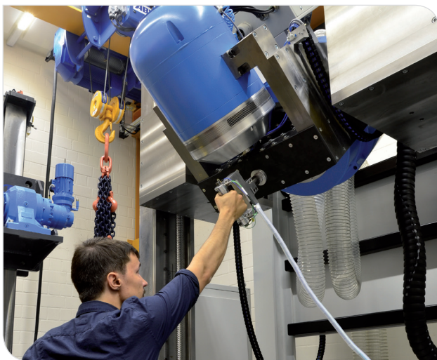
Anwender am AIP bei einer Messung von dynamischen Eigenschaften des Hand-Arm-Systems bei Über-Kopf-Haltung
