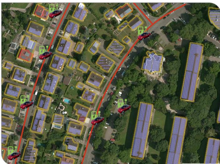
Automatisierte Erkennung und Inventarisierung von Energiesystemen am Beispiel von Photovoltaikanlagen (Abbildung: Google Maps/greenventory).
