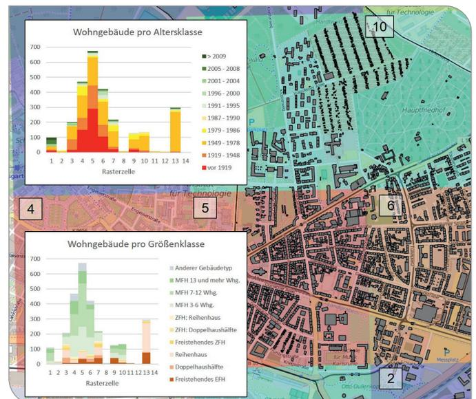
Analyse des Energieverbrauchs für Strom, Wärme und Mobilität: Die Abbildung zeigt eine Analyse der energetischen Gebäudestruktur (Abbildung: greenventory).
