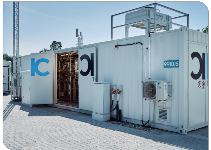
Container-Anlage zur Herstellung von e-Fuels. (Foto: Cynthia Ruf, KIT)
