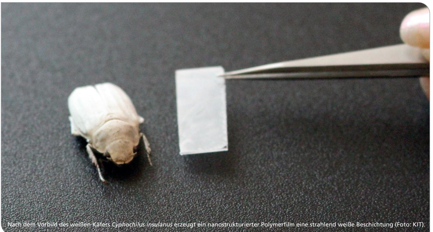
Nach dem Vorbild des weißen Käfers *Cyphochilus insulanus* erzeugt ein nanostrukturierter Polymerfilm eine strahlend weiße Beschichtung (Foto: KIT).
