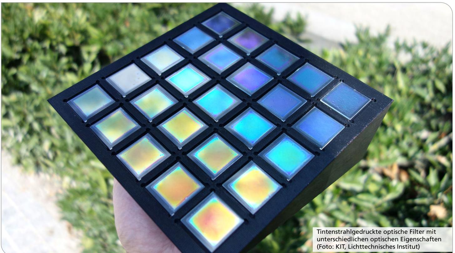
IR-Bereich wird durch die Dicke der einzelnen Schichten und den Aufbau des Stapels bestimmt. Die optimale Nanometer-Präzision wird durch die Steuerung der Tintenkonzentration und der Anzahl der pro Flächeneinheit abgedruckten Tintentröpfchen erreicht.
